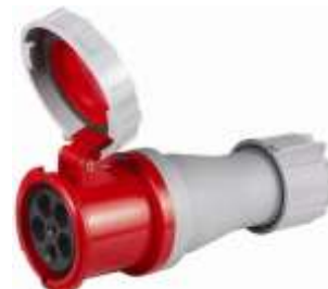
Prise EURO CEE 125/5 rouge triphasé (charge admise: 125A, 400V, jusqu'à 86.5 kW) Steckdose EURO CEE 125/5 rot dreiphasig (zugelassene Leistung: 125A, 400V, bis 86.5 kW)
