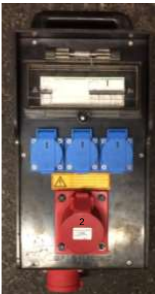
Prise EURO CEE 16/5 rouge triphasé (charge admise: 16A, 400V, jusqu'à 11 kW) Steckdose EURO CEE 16/5 rot dreiphasig (zugelassene Leistung: 16A, 400V, bis 11 kW)
