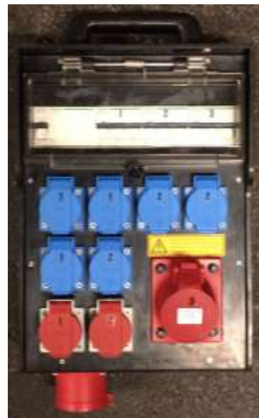
Prise EURO CEE 32/5 rouge triphasé (charge admise: 32A, 400V, jusqu'à 22.1 kW) Steckdose EURO CEE 32/5 rot dreiphasig (zugelassene Leistung: 32A, 400V, bis 22.1 kW)
