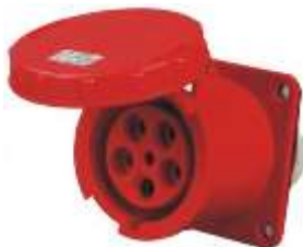
Prise EURO CEE 63/5 rouge triphasé (charge admise: 63A, 400V, jusqu'à 43.5 kW) Steckdose EURO CEE 63/5 rot dreiphasig (zugelassene Leistung: 63A, 400V, bis 43.5 kW)
